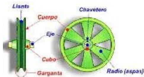
En los sistemas mecánicos podemos encontrar con dos **tipos básicos** de poleas: *fijas* y *móviles*. El conjunto formado por poleas fijas y móviles recibe el nombre de **polipasto** (fig. 13).
