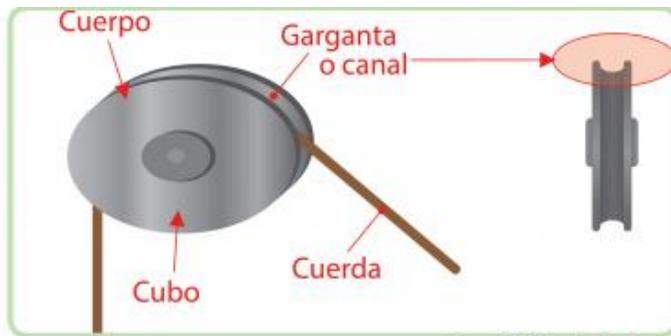
Figura 7. Partes de la polea
