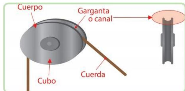
Figura 7. Partes de la polea
